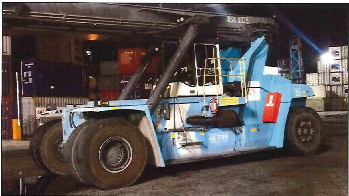
Figura 1. Empilhadeira de grande porte (Reach-Stacker), RSK-0025.
